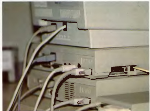
Parte trasera de la unidad central y el disco duro junto al controlador de impresora
